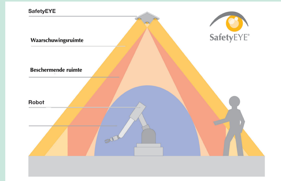
Camerasysteem SafetyEYE scant de omgeving af, detecteert wanneer zich mensen in de gevaarlijke zone bevinden en stuurt op basis daarvan specifieke acties aan.
